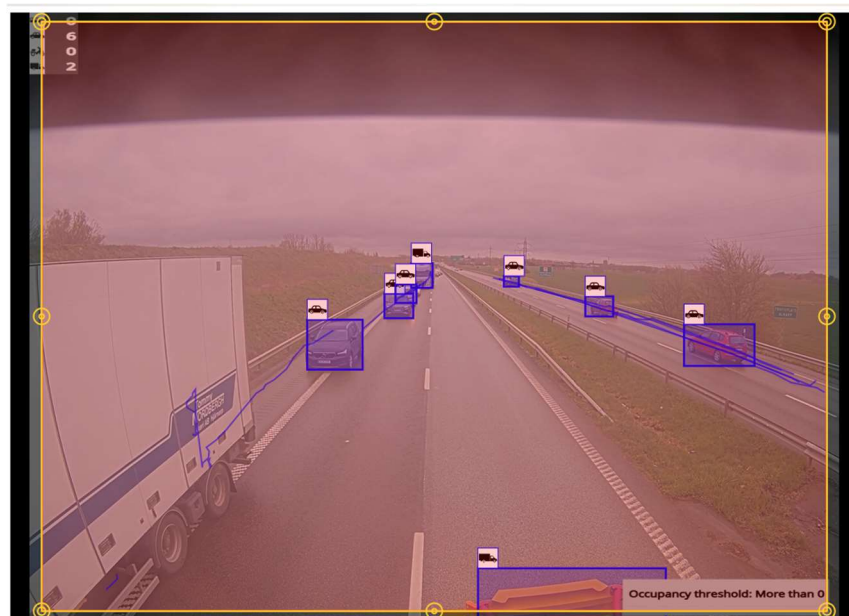
Fig. 3. ett exempel av bildetektion och verifiering med kamera
